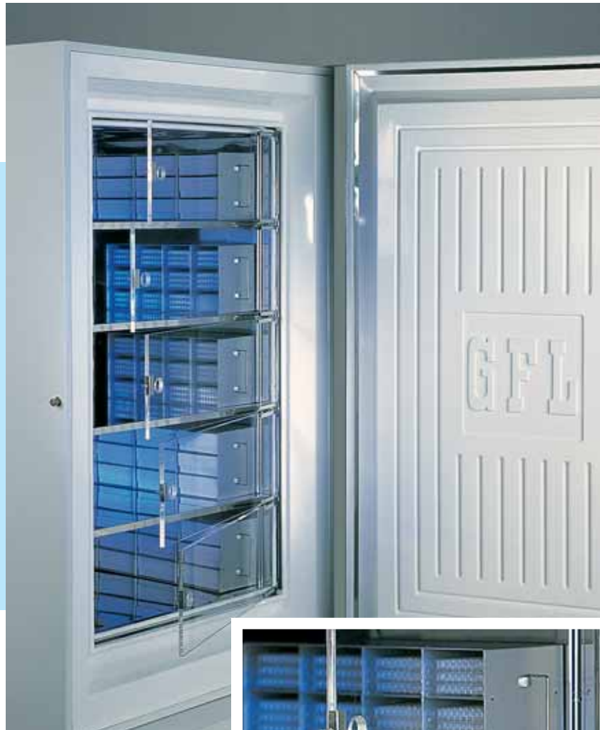
6485 Tiefkühlschrank, 500 Liter, Sonderausstattung mit fünf Innenfächern und Innentüren aus 10 mm dickem Acrylglas mit Griffloch. Lagersystem für Testplatten und Boxen.
