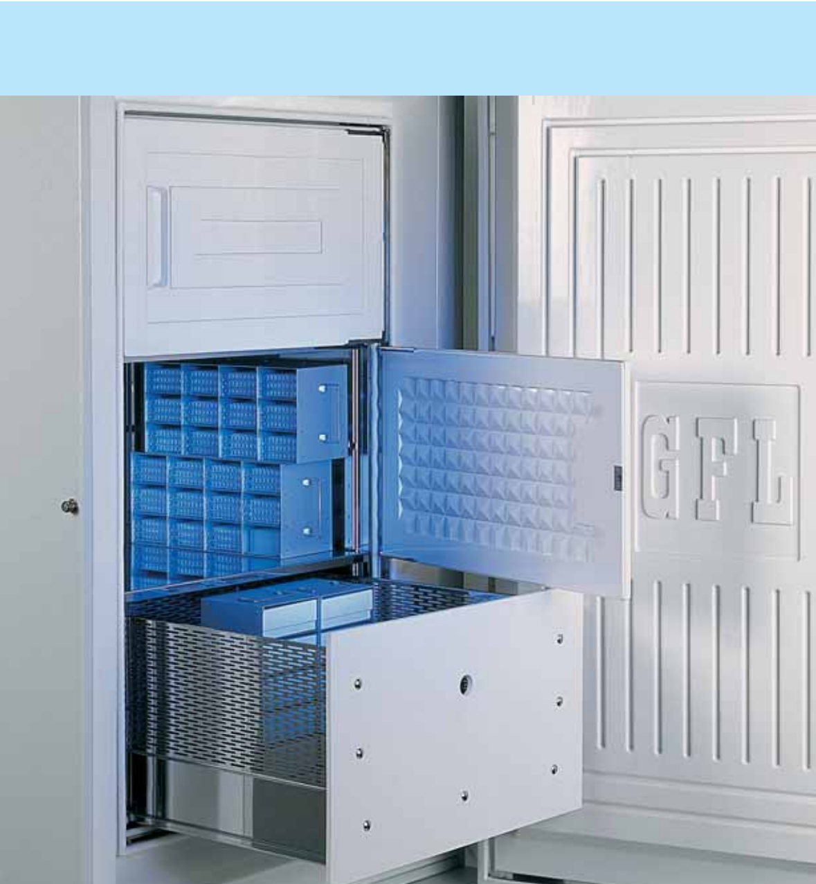
6485 Tiefkühlschrank, 500 Liter, Sonderausstattung mit zwei Standardfächern und großer Schublade aus Edelstahl-Rostfrei mit gelochter Seitenerhöhung und 10 mm dicker Isolier-Kunststoffabdeckung mit Griffloch. Lagersystem für Testplatten und Boxen.
